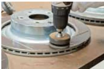
車両からブレーキ・ローターを外さず、車両に取り付けたまま研磨する場合は、アイドルリング回転させながら、作業してください。
